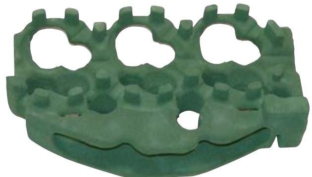
Voorbeelden van enkele geprinte zandvormen en kernen.
